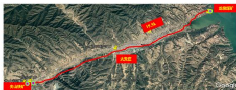
2016年尖山铁矿至尹家窑村管线启用后，下游大夫庄至尹家窑村段管线1年内穿孔20余处。
